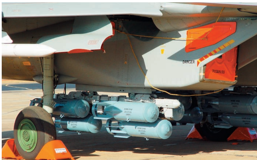
Бомбардировочное вооружение самолета Су-30МКИ ВВС Индии: на многозамковых держателях под каждым воздухозаборником подвешивается по шесть осколочно-фугасных авиабомб ОФАБ-250-270
